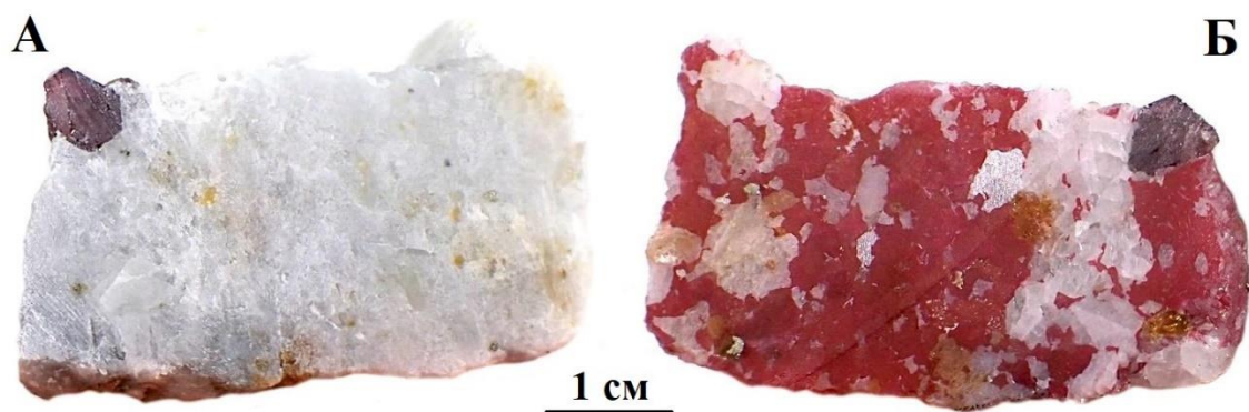
Рисунок 10 – Результат селективного окрашивания шпинель-содержащего мрамора в образце РН-06-12. А – половина образца без прокрашивания, Б – вторая половина того же образца после прокрашивания. Видны структурные взаимоотношения кальцита (красное) и доломита (белое).
