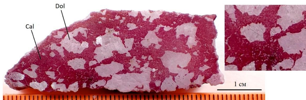
Рисунок 14 – Фрагмент кальцит-доломитового мрамора (после селективного окрашивания, образец PH-15-05); Cal – кальцит, Dol - доломит
