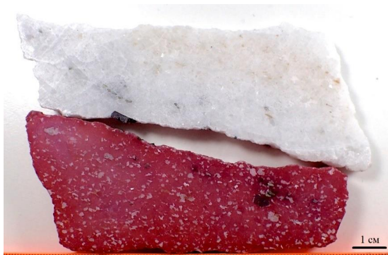
Рисунок 34 Ксеноморфный кальцит (окрашен в красный цвет) в доломит-кальцитовом мраморе в образце РН-06-13
