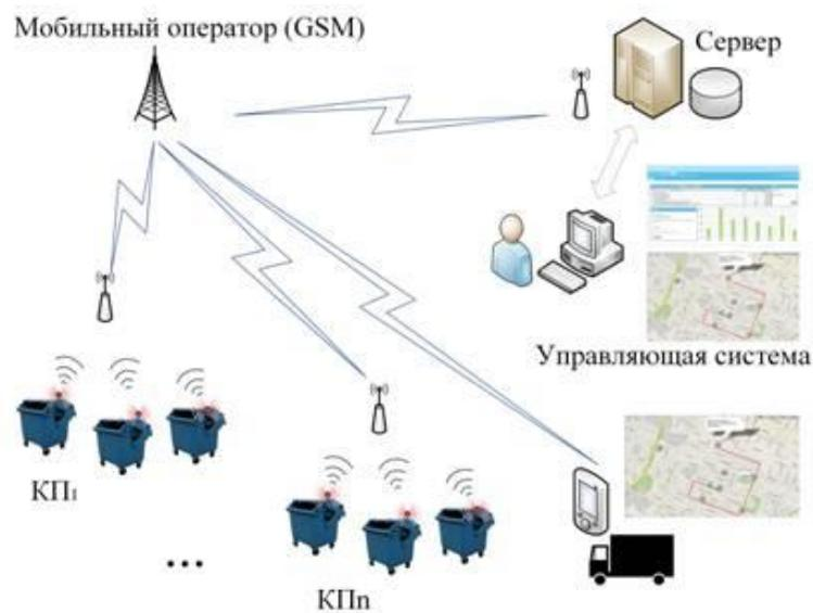
Рисунок 1 – Схема работы системы «Чистый город»
