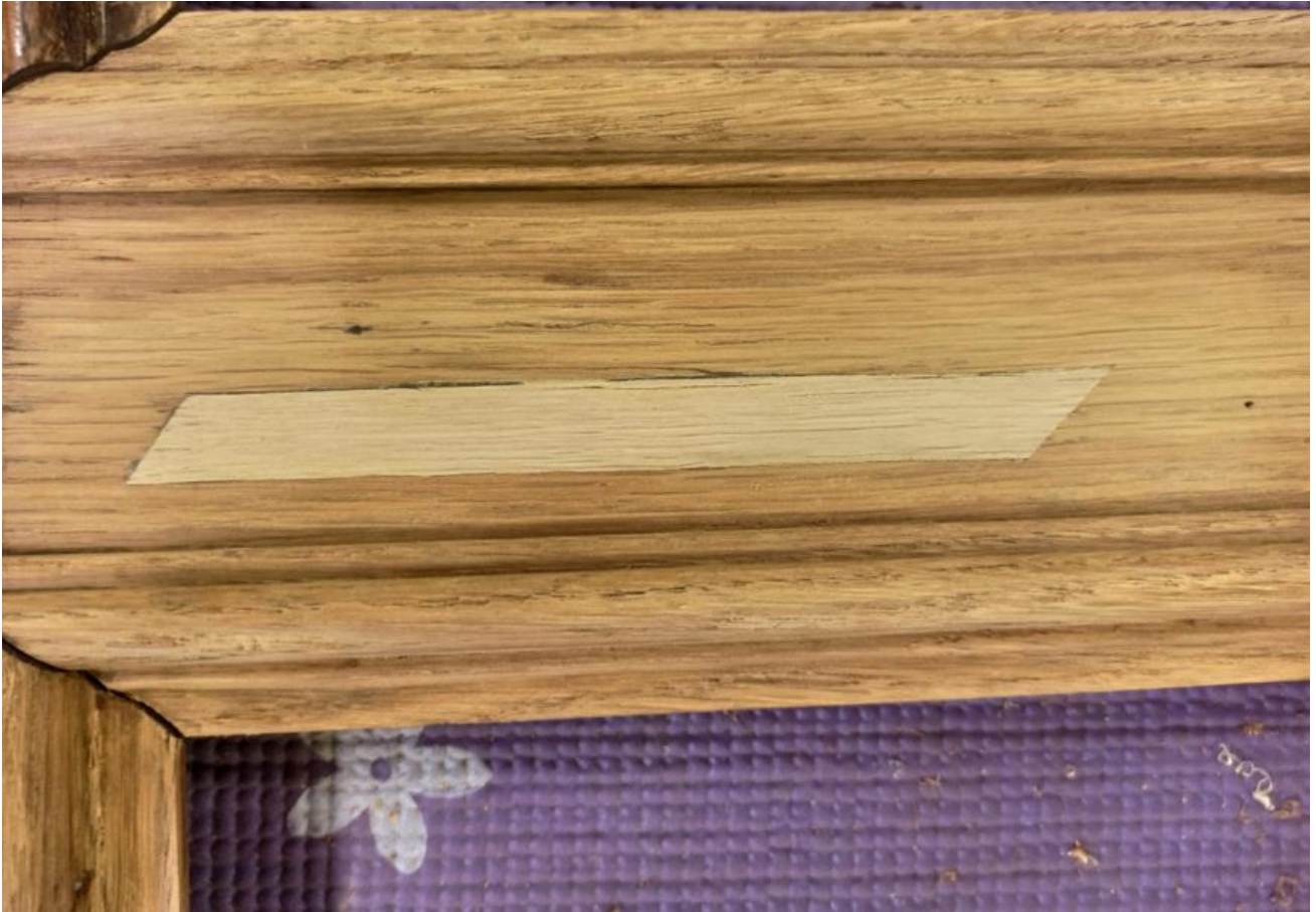
Фото №60: Изготовление вставки в место утраты фанеровки средника правой дверцы.
