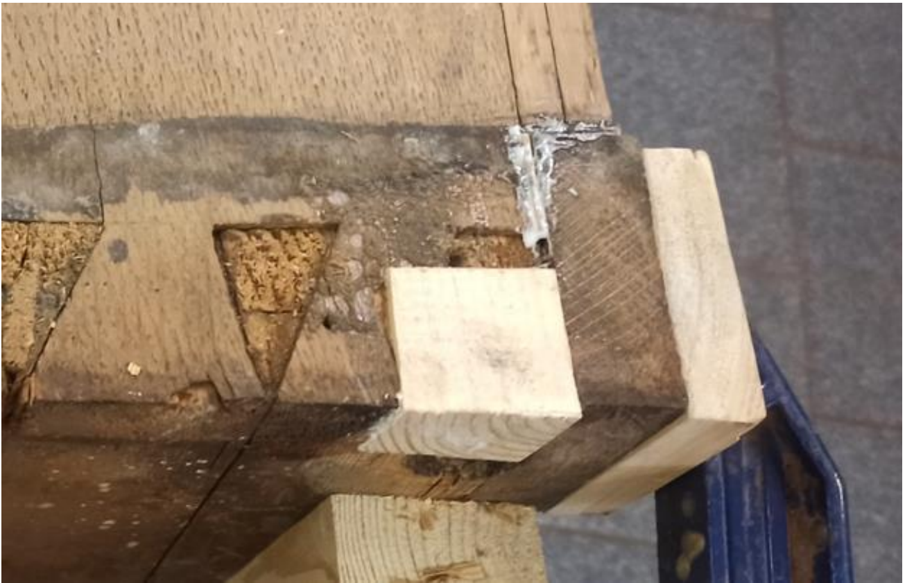
Фото №47: Изготовление вставки в место утраты массива шипового соединения левой боковой стенки.
