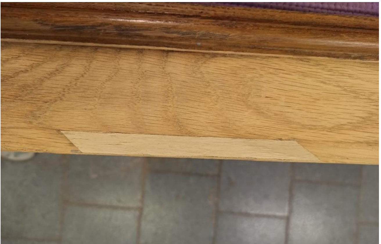
Фото №59: Изготовление вставки в место утраты фанеровки правой дверцы.
