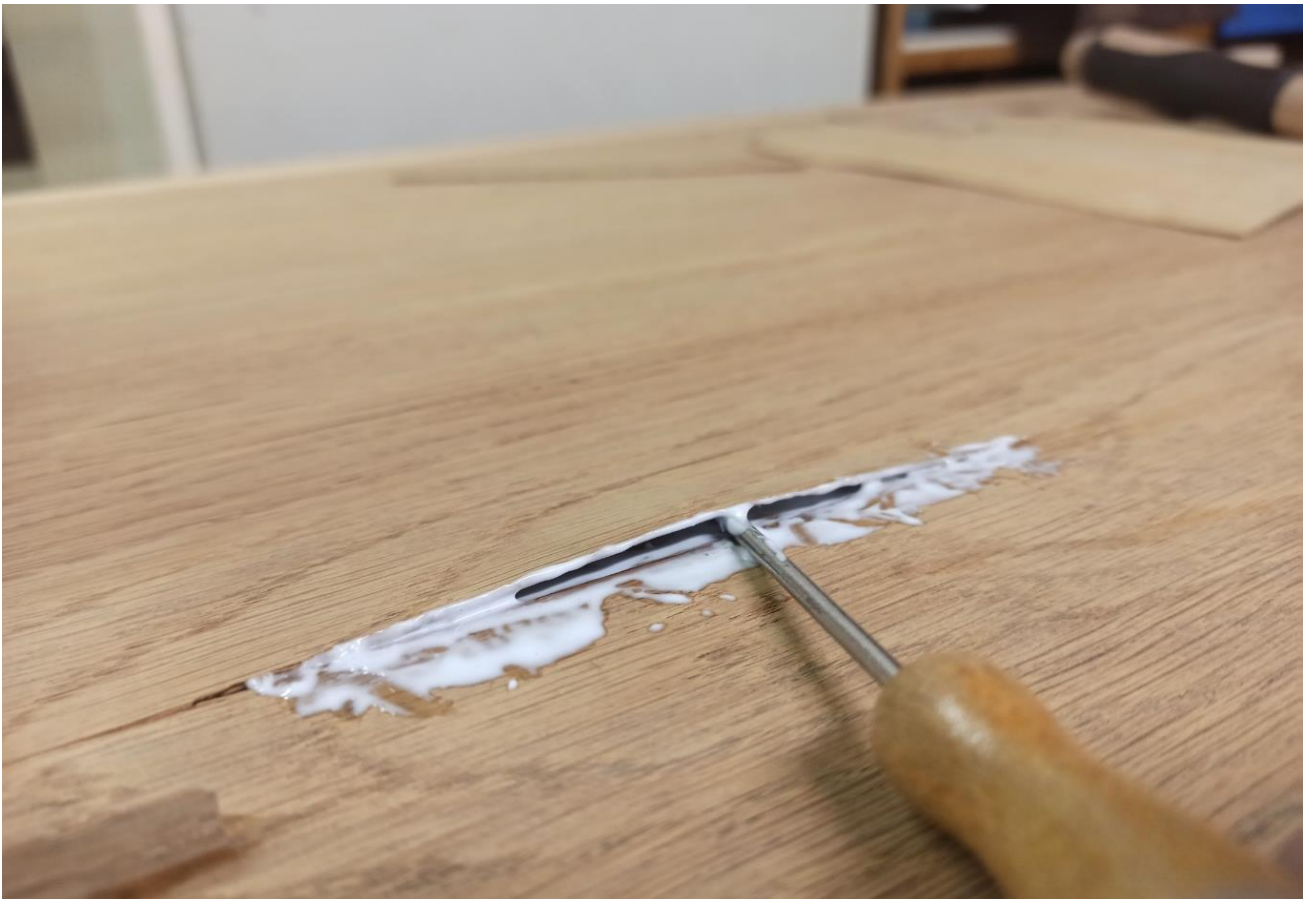
Фото №39: Процесс проклейки фанеровки в местах отхода от основы правой боковой стенки.
