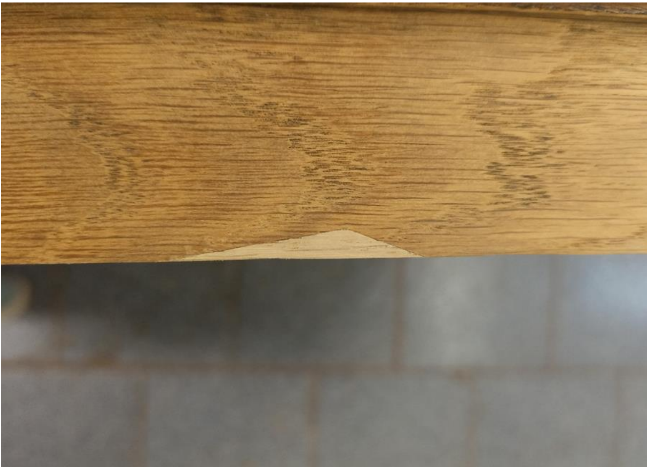
Фото №57: Изготовление вставки в место утраты фанеровки правой дверцы.
