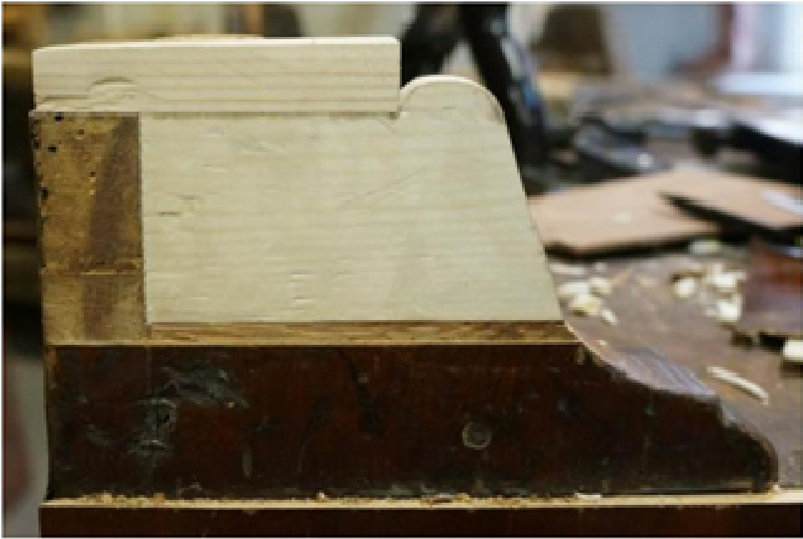
Фото№ 29: Нарращивание левой передней ножки.
