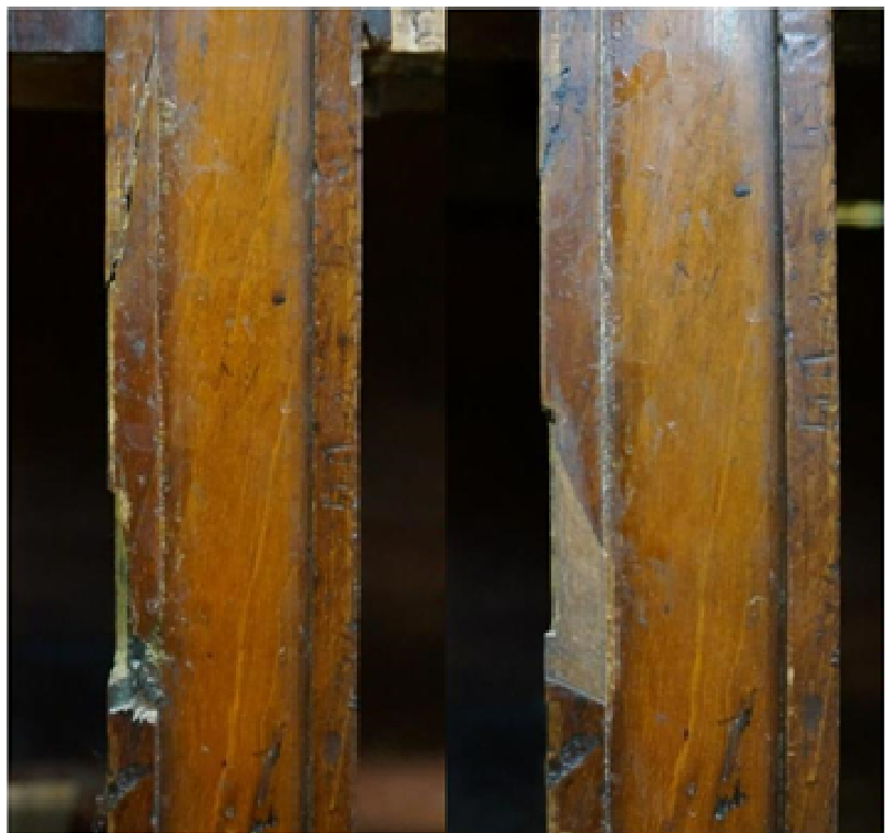
Фото№ 13,14,15: Подклейка платиков, вставка на месте петли центральной дверцы.
