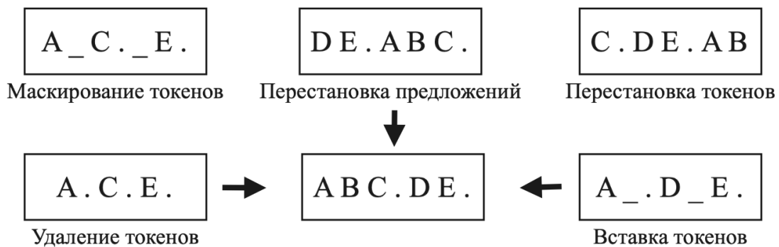
Рис. 1: Схема искажения входных данных, используемая в процессе обучения модели BART.
