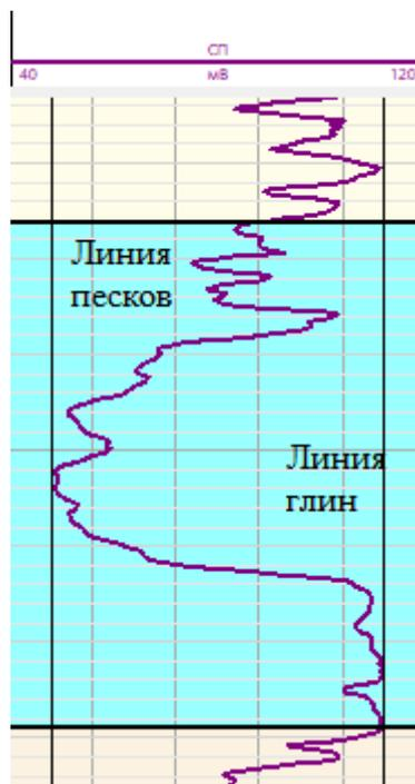
Рис.5.17: Определение линии песков ( $U_{psmin}$ ) и линии глин ( $U_{psmax}$ ) в скв.2
