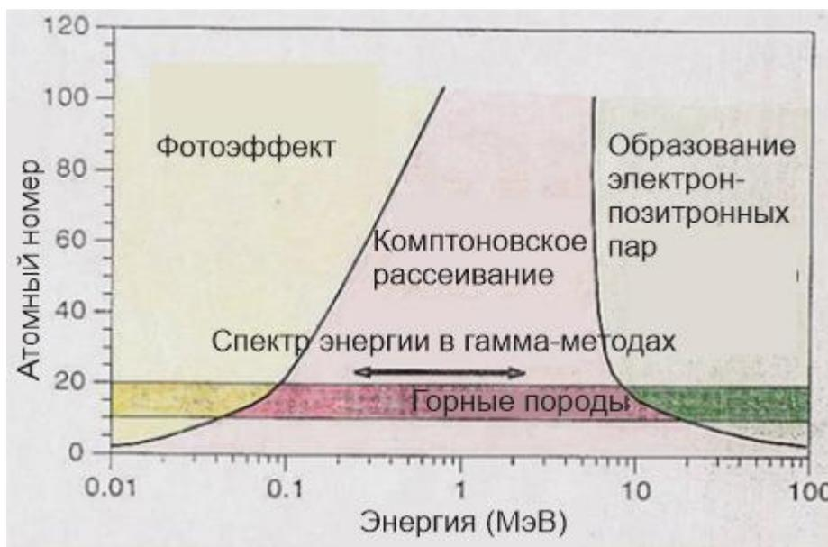
Рис.2.16: Соотношение между тремя процессами взаимодействия  $\gamma$ -квантов со средой в зависимости от энергии фотона и атомного номера поглощающей среды
