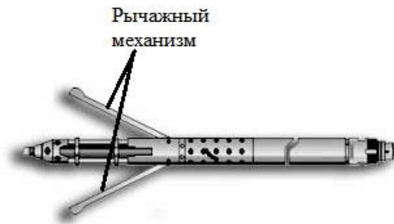
Рис.2.20: Механический каверномер [<https://rosprombur.ru/kavernomer.html>]
