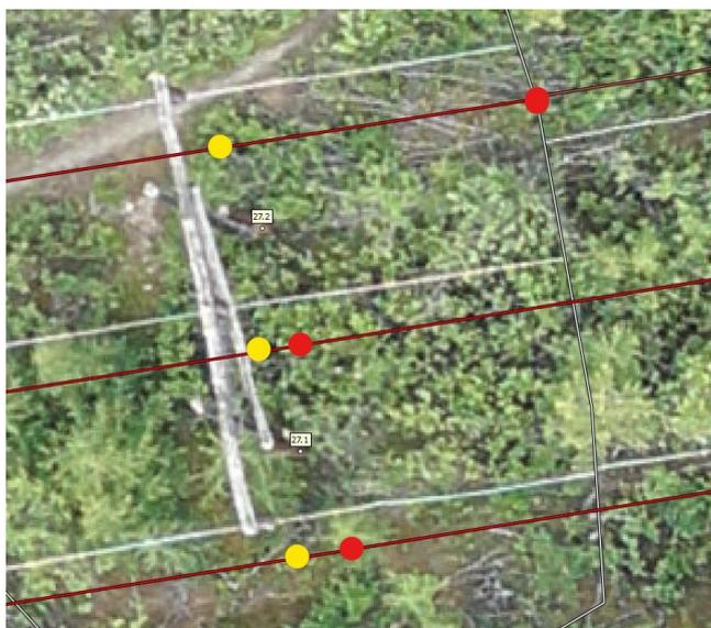
*Рис. 23. Реальное положение изоляторов (жёлтым) и определённое инструментом неверное положение (красным)*
