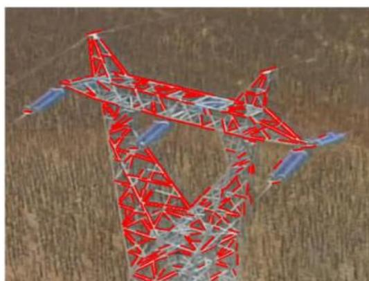
*Рис. 4. Найденные линии на опоре [10]*
