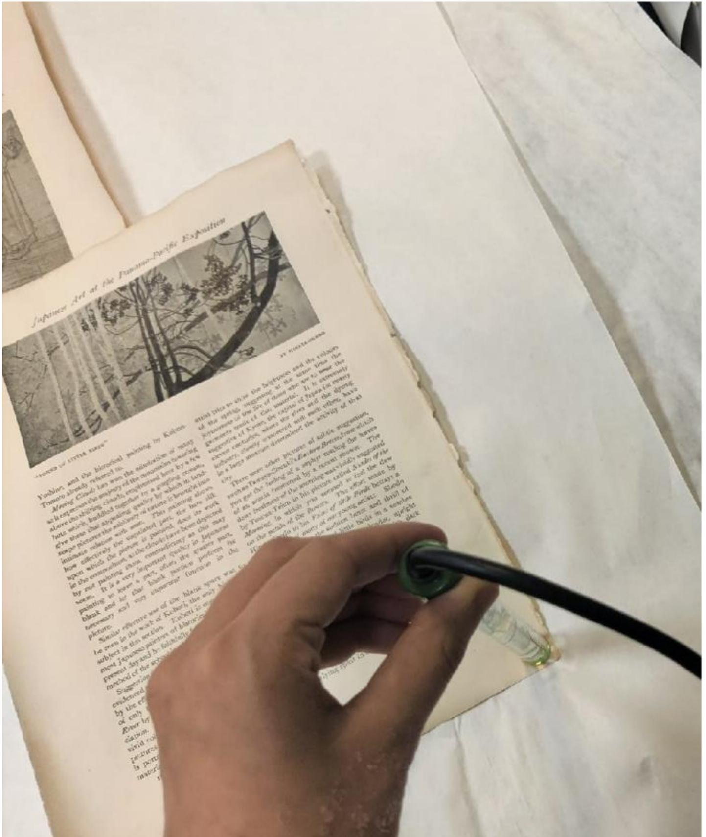
Фото №26: Снятие проб рН-метром с контактными электродам после нейтрализации кислотности бумаги
