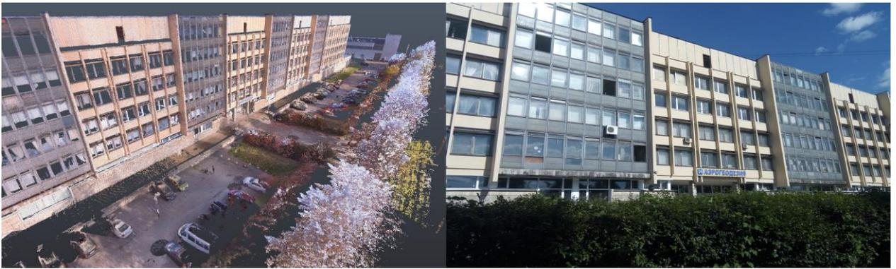
Рис.35. Облако ТЛО НЛС здания АО "Аэрогеодезия" (слева) и фотография этого же здания (справа)
