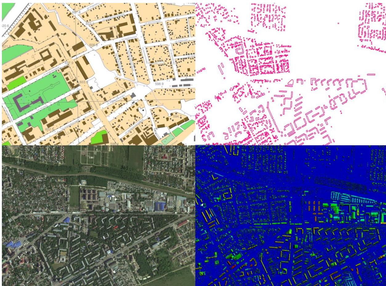
Рис.25. Цифровой топографический план (левый верхний угол), векторный слой контуров зданий (правый верхний), ЦОФП (левый нижний), ЦММ построенная по данным ВЛС (правый нижний)
