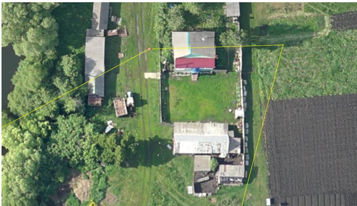
Рис.17. Искаженное изображение дома из-за проходящей по нему линии порезов
