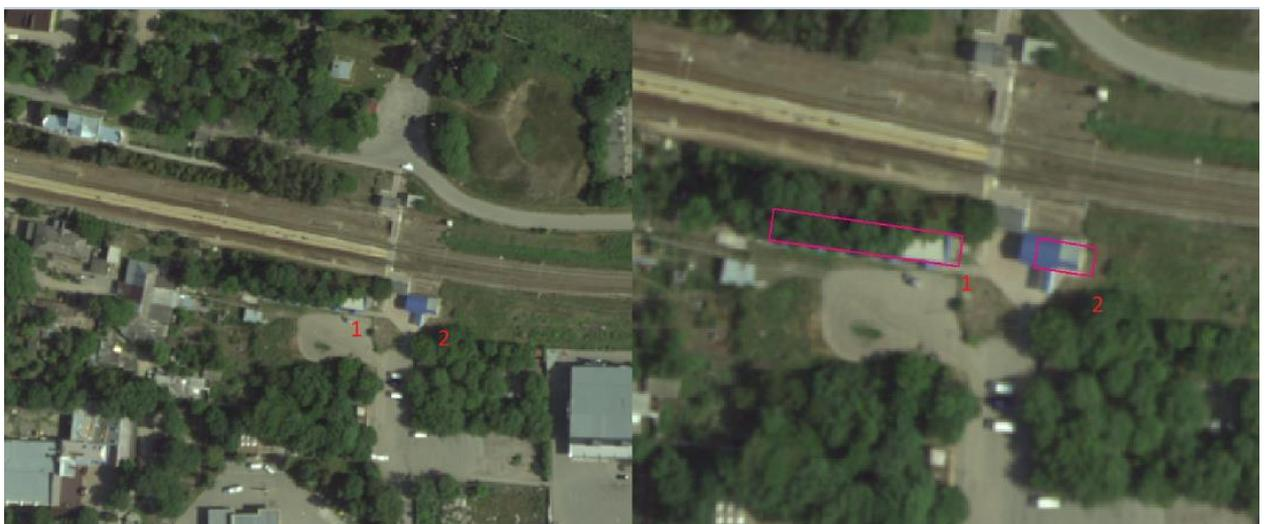
Рис.30. Нечитаемые контуры границ здания (под цифрой 1) на ЦОФП
