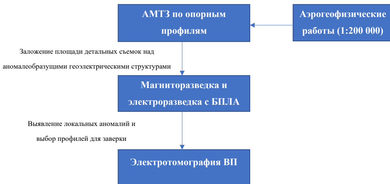
Рисунок 10. Общая схема комплекса геофизических методов
