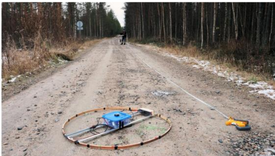
Рисунок 5. Портативный источник ЭМ поля в двухдроновой системе
