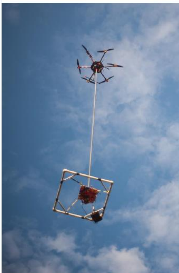
Рисунок 7. Беспилотная система SibGIS UAS в варианте для электромагнитного зондирования в полете
