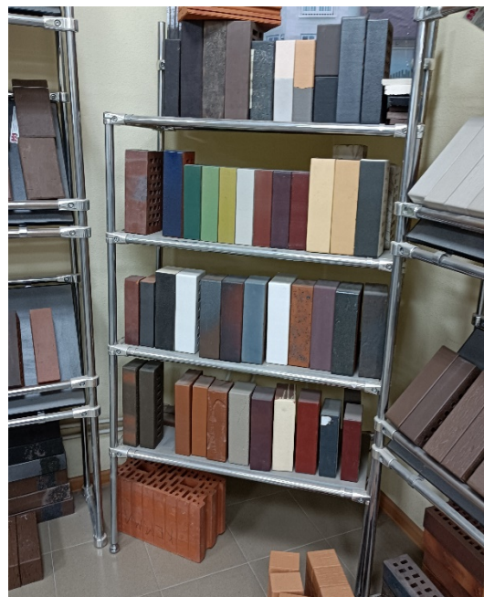
Рис. 12. Ангобированные фасадные кирпичи в лаборатории завода. Фото автора.
