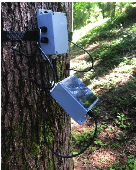
Рисунок 5. Устройство «TreeTalker»
