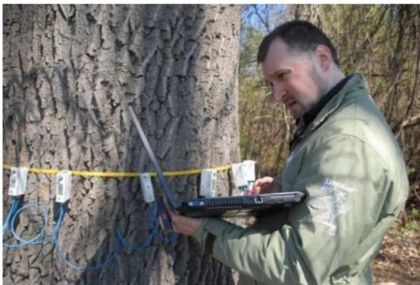
Рисунок 7. Процесс обследования дерева прибором «Arbotom»
