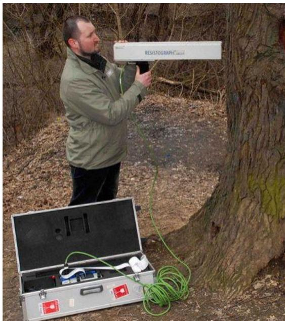
Рисунок 6. Процесс обследования дерева прибором «Resistograph» (URL: <https://rosdrevo.ru/news/2014-04-09/>)
