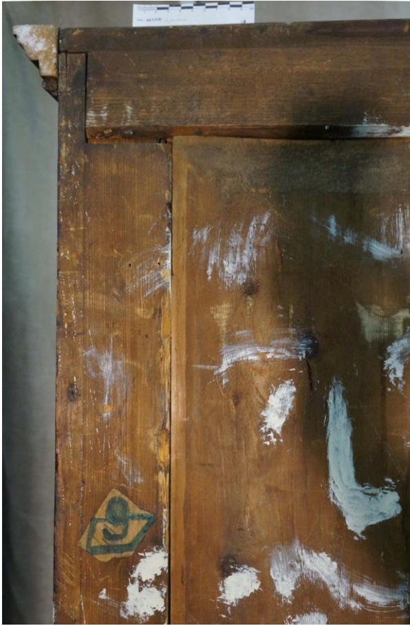
Фото №29. Деструкция древесины задней рамы.
