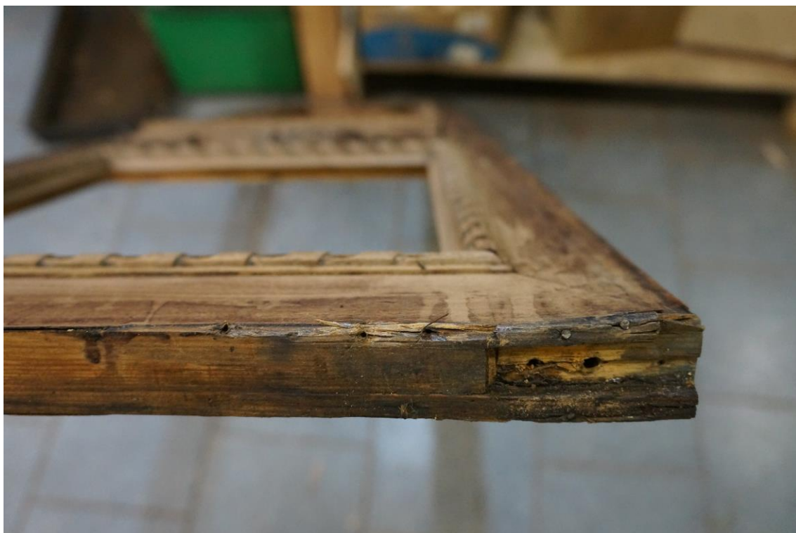
Фото №53. Расслоение основы и отслоение фанеровки. Нижняя часть правой дверцы.
