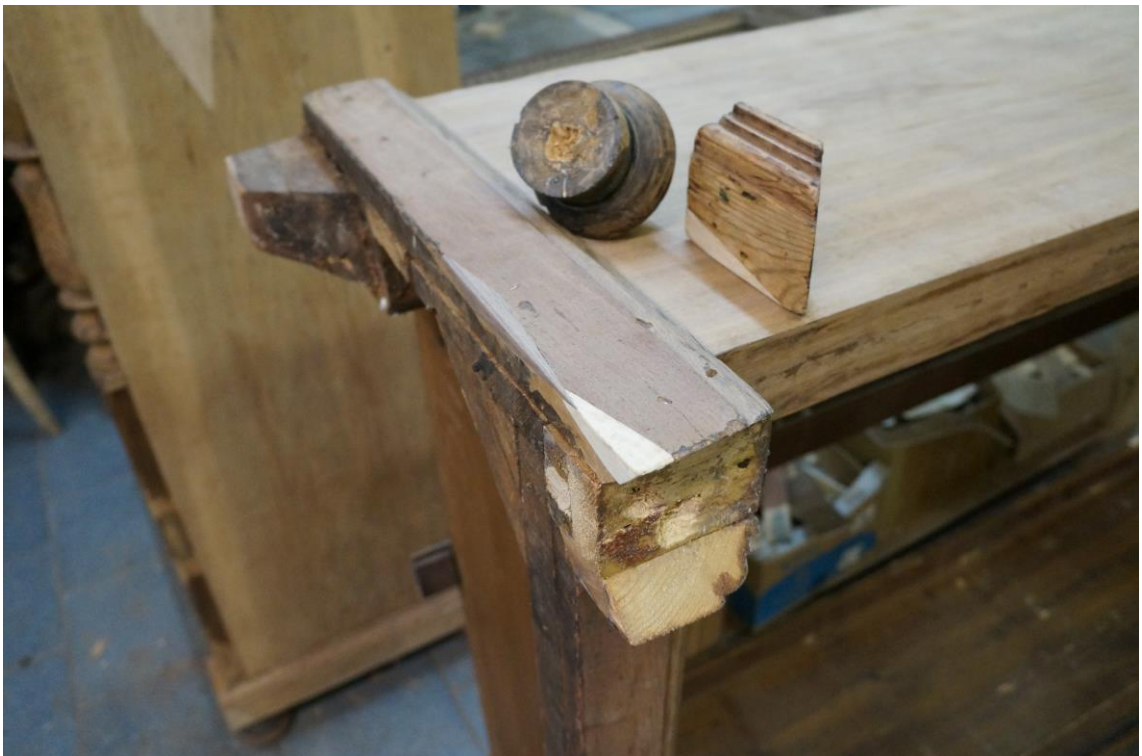
Фото №62. Снятие левой передней ножки.
