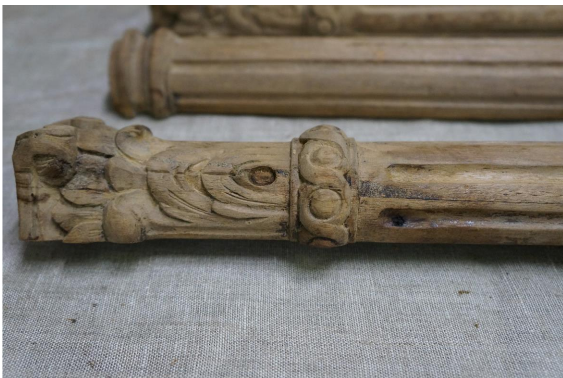
Фото №47. Утрата массива в области капители. След от гвоздя.
