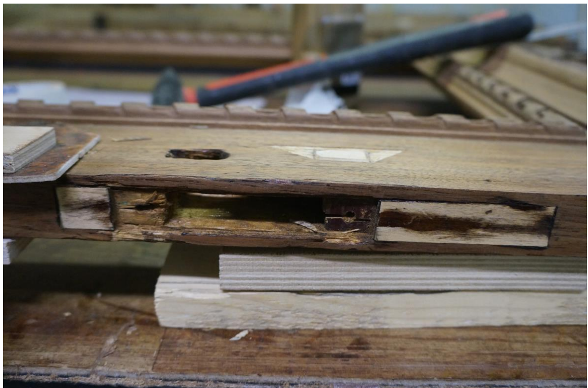
Фото №71. Изменение размера замкового гнезда вставками из берёзы.
