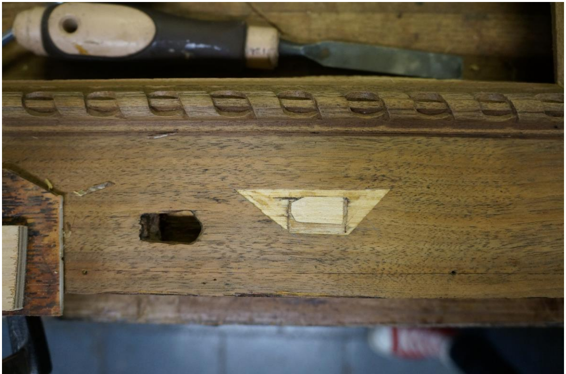
Фото №70. Заделка оригинального гнезда ключевины.
