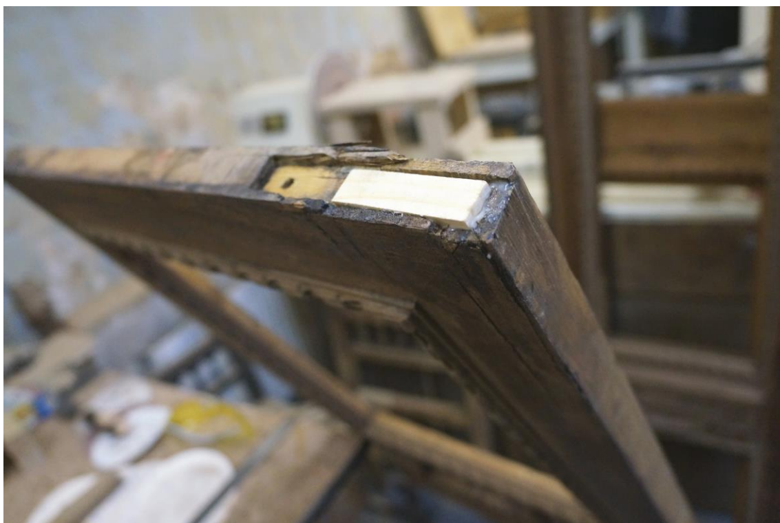
Фото №53. Расслоение основы и отслоение фанеровки. Нижняя часть правой дверцы.
