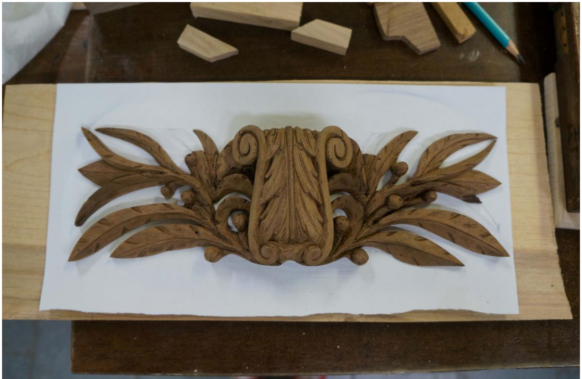
Фото №87. Установка центральной резьбы карниза на фанеру для восполнения утрат.
