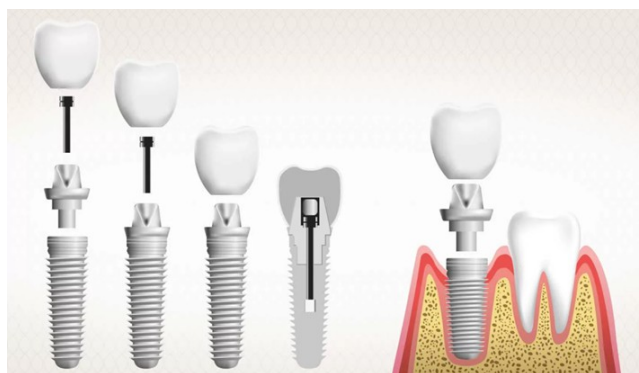
Рис. 22 Конструкция на основе имплантата Бранемарка. Имплантат фиксируется в костной ткани. Для установки коронки к имплантату присоединяют абатмент – аналог культи зуба.
