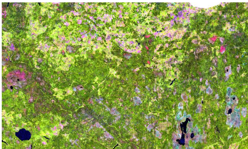
Рисунок 14. Пример синтезированного изображения в искусственных цветах, комбинация 6-5-4 для Landsat-8 (составлен автором)
