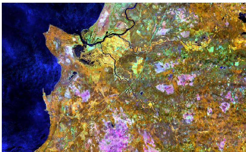
Рисунок 12. Пример синтезированного изображения в искусственных цветах, комбинация 5-6-4 для Landsat-8 (составлен автором)
