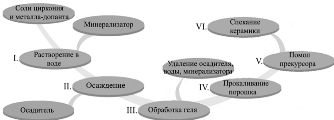
Рис. 14. Схема методики получения прекурсоров и керамики на основе ZrO_2
