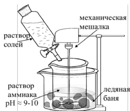
Рис. 15. Схема оборудования для II этапа получения образцов ZrO_2
