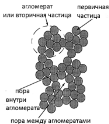
Рис. 13. Схематичное изображение структуры агломерированного порошка [42]
