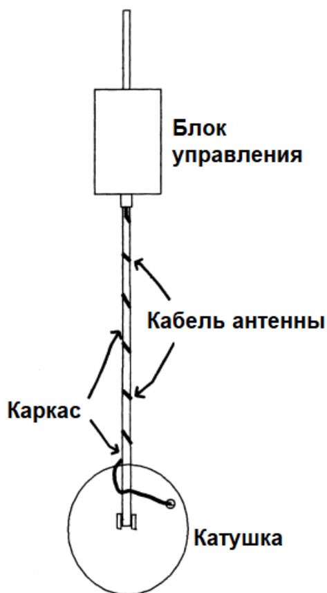
Рисунок 4. Схематичное строение металлоискателя
