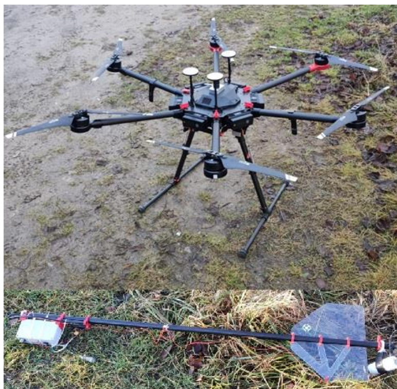
Рисунок 16. БПЛА DJI Matrice 600 и гондола-магнитометр на основе ММРОС-1
