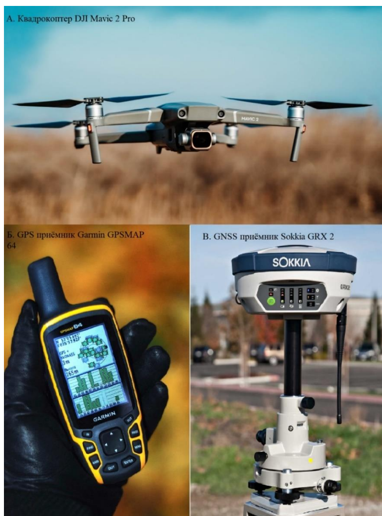
Рисунок 10. Используемая аппаратура: А - квадрокоптер DJI Mavic 2 Pro; Б - GPS приёмник Garmin GPSMAP 64; В - GNSS приёмник Sokkia GRX-2
