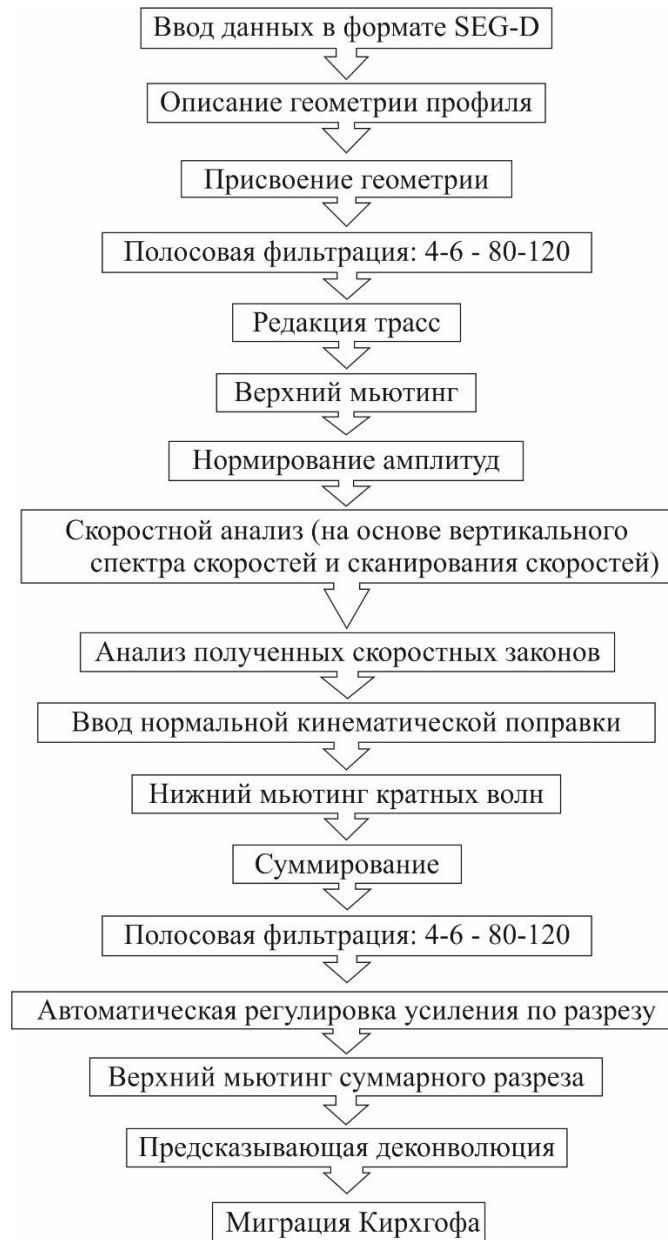
Рисунок 10 Граф обработки сейсмических данных 66 РАЭ.
