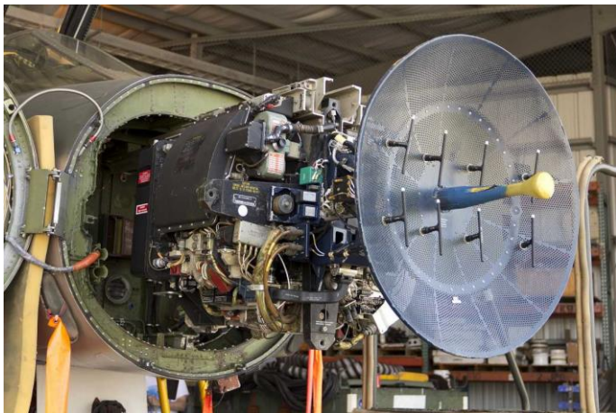
Рис. 30. Приборы пассивного дистанционного зондирования а – радар Nangong N-25J ( https://anterra.miraheze.org/ ), б – авиационный лидар видимого диапазона ( http://quantumoptics.ru/ )
