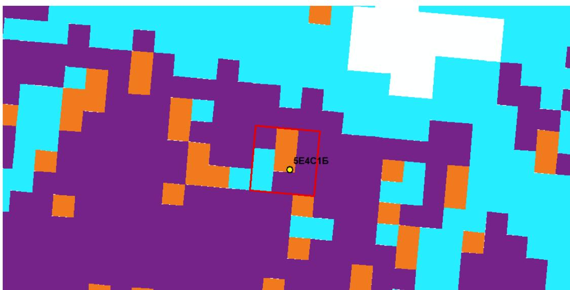
Рис. 4.11 Пример верификации на точке исследования (*измеренный на местности породный состав 5E4C1B; породный состав по классификации насаждений, ограниченный девятипиксельным полигоном – 6E2C2M*)
