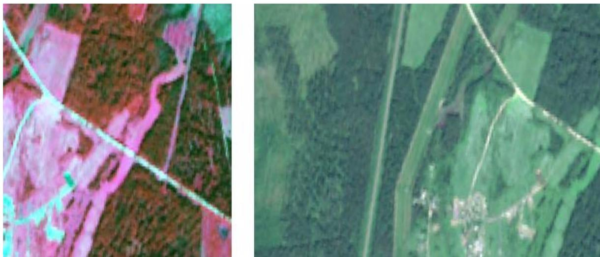
Рис. 4.2 Сравнение объектов инфраструктуры на спутниковом снимке в «искусственных цветах» (слева) и в «естественных цветах» (справа)
