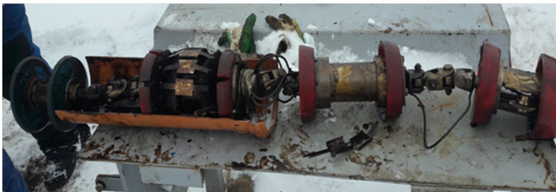
Рис. 1.1.3: Повреждения внутритрубного дефектоскопа.
