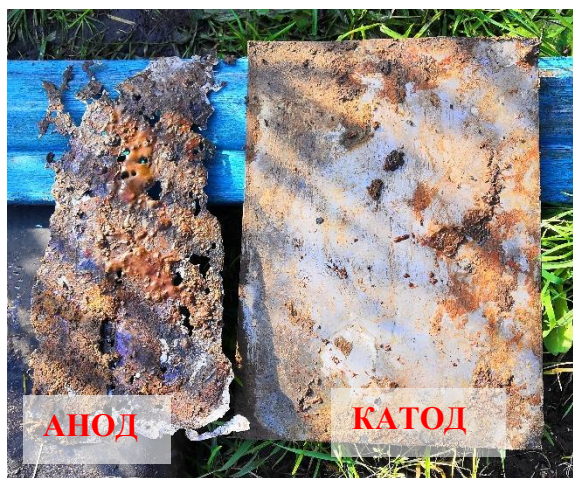
Фото.2. Анод и катод после проведения опыта.
