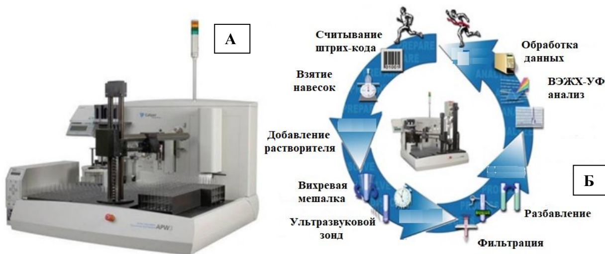
Рисунок 14 – Внешний вид прибора Zymark APW (А) и цикл его работы (Б) [222]
