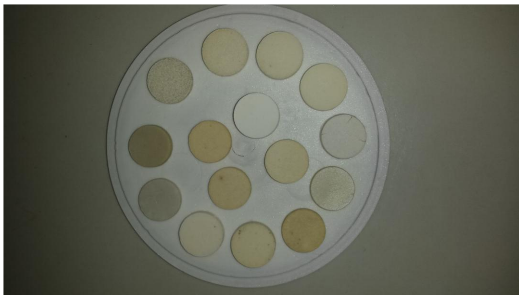
Рисунок 8 – Фотография таблеток образцов в системе La_2O_3 - Y_2O_3 - HfO_2 , сделанная после проведения второй термической обработки образцов при максимальной температуре 1973 К
