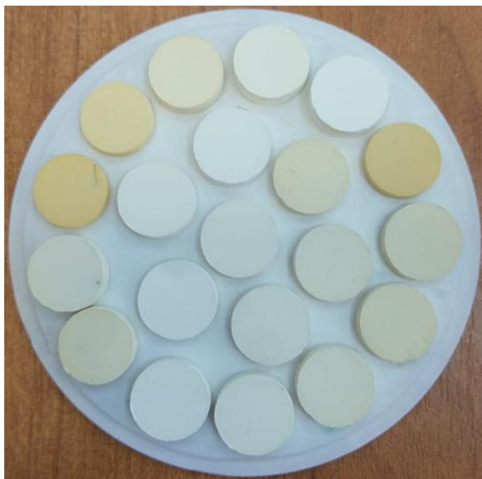
Рисунок 9 – Фотография таблеток образцов в системе \text{Sm}_2\text{O}_3\text{-Y}_2\text{O}_3\text{-HfO}_2 , сделанная после проведения второй термической обработки образцов при максимальной температуре 1973 К
