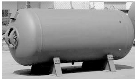
Рис. 2. Элемент реальной конструкции: цилиндрическая оболочка с торцевой крышкой.
