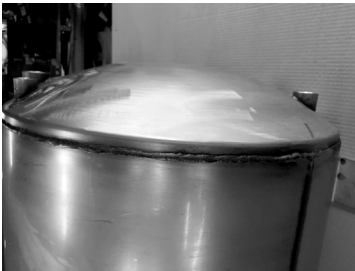
Рис. 2. Элемент реальной конструкции: цилиндрическая оболочка с торцевой крышкой.
