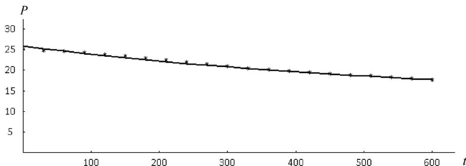
Рис. 2. Прочность (ось ординат) при растяжении полипропиленовых волокон с наночастицами фотокатализатора  $\text{TiO}_2$  как функция времени облучения (ось абсцисс) Звездочки на графике — модельные данные, кривая линия — результаты аппроксимации модельных данных уравнением (7), коэффициенты которого получены методом Монте-Карло.
