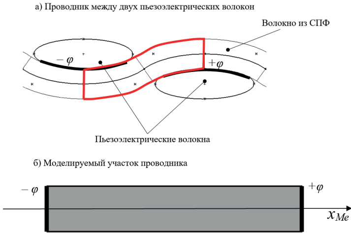
Рис. 7. Расчетная схема для металлического компонента.
