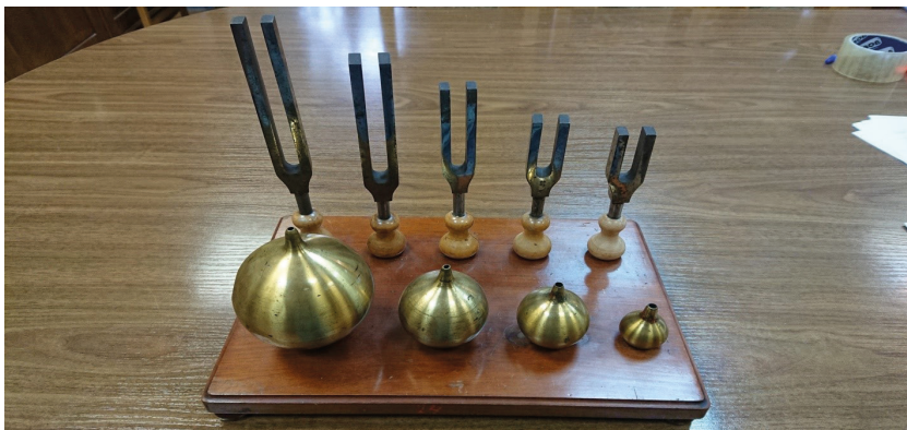
Рис. Набор камертонов для «основных гласных» немецкого языка с резонаторами Гельмгольца; произведен в конце XIX в. Рудольфом Кёнигом (коллекция камертонов Л. В. Щербы; кафедра фонетики и методики преподавания иностранных языков СПбГУ; фото сделано 07.08.2019 У. Е. Кочетковой)
