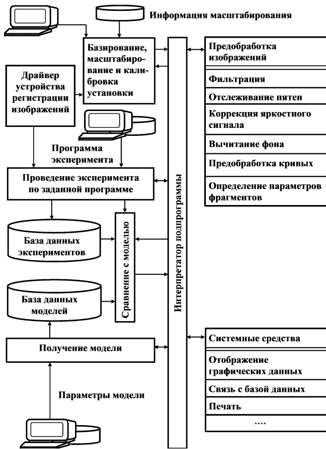
Рис. 5. Структура программного обеспечения инструментального модуля
