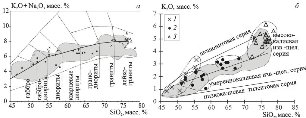
Рис. 5. Диаграммы ( $\text{Na}_2\text{O} + \text{K}_2\text{O}$ ) —  $\text{SiO}_2$  (а) поля составов по (Петрографический кодекс..., 2009);  $\text{K}_2\text{O}$  —  $\text{SiO}_2$  (б) по (Peccerillo and Taylor, 1976) для интрузивных пород Няганской впадины. Точки составов: 1 — мандычанского, 2 — наяханского, 3 — омсукчанского комплексов. Для сравнения показаны поля составов вулканитов Охотского сектора ОЧВП по (Тихомиров, 2018)
