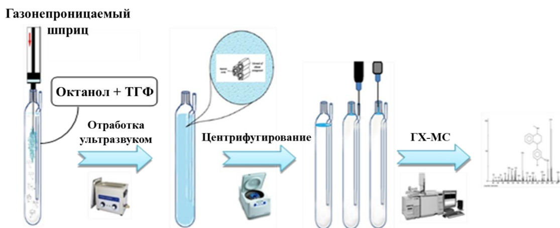
Рисунок 9. Схема определения антидепрессантов методом ГХ-МС с предварительным извлечением аналитов в фазу n-октанола, используемого в качестве экстрагента [129]
