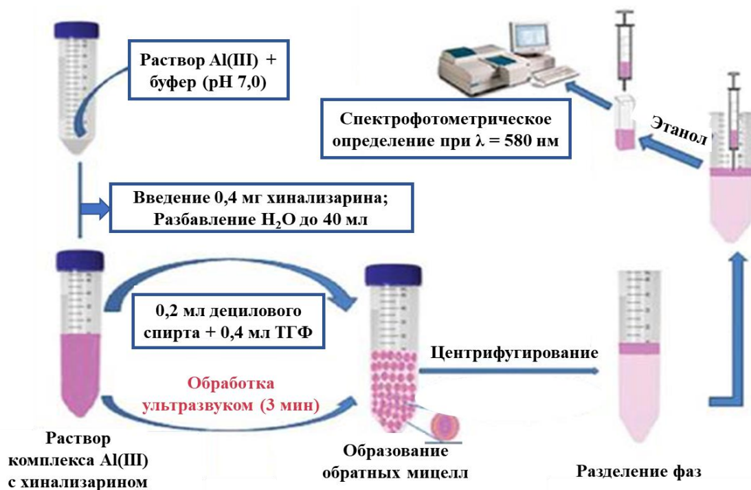
Рисунок 11. Схема спектрофотометрического определения Al (III) предварительным извлечением хинализаринового комплекса металла в фазу децилового спирта, используемого в качестве экстрагента [132]
