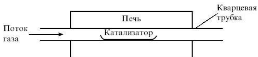
Рис. 9. Общая схема установки, используемая в методе CVD
