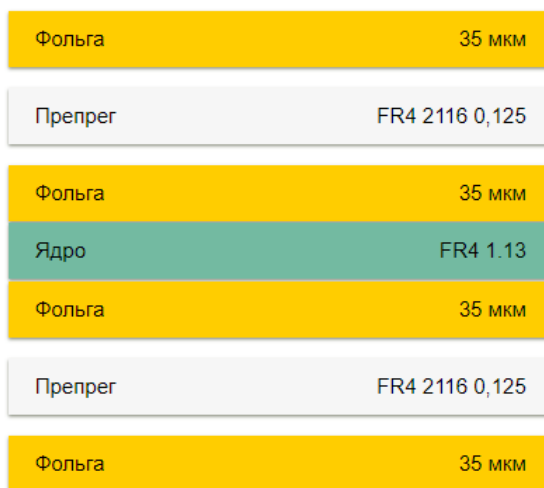
Рис. 21: Топология слоев печатной платы
