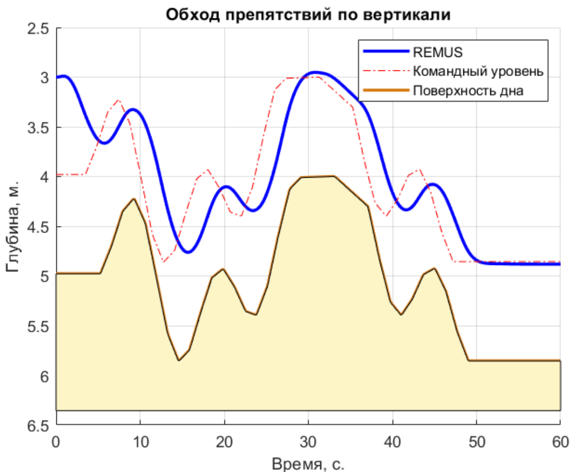
Рис.13. Результаты работы управления на тестовой поверхности дна №2
