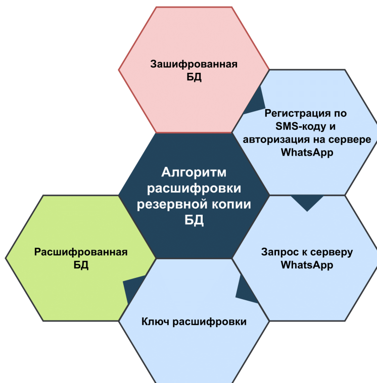
Рис. 1: Алгоритм расшифровки резервной копии
