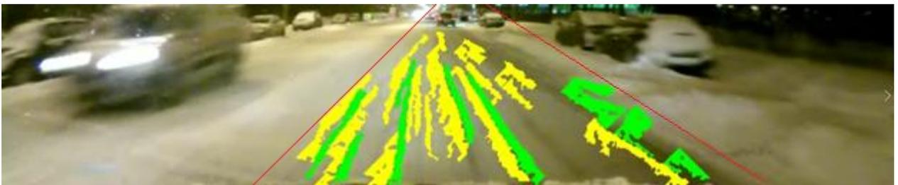
Рис. 25 – Вид кадра после фильтрации методом ограничивающих прямых с отрисованными прямыми.
