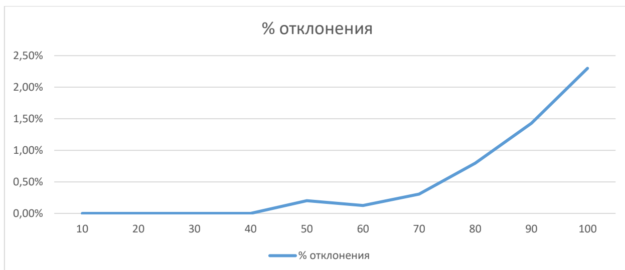
Рисунок 4. Отклонения решений ММК от МВиГ в зависимости от размерности задачи
