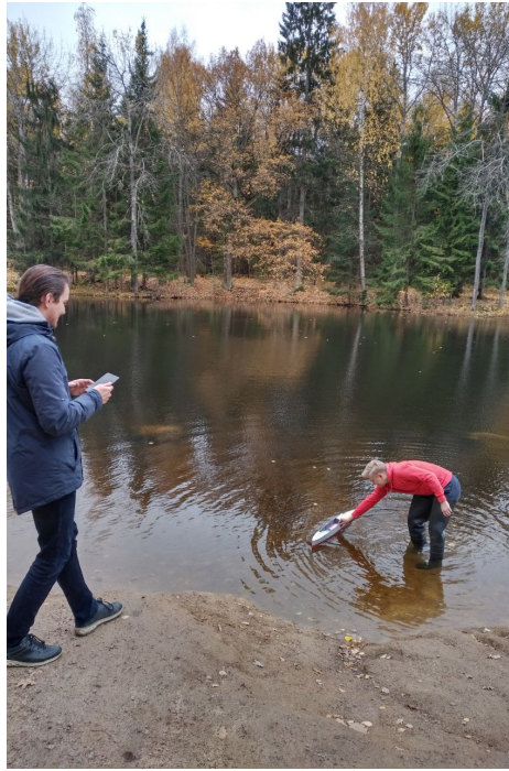
Рис. 14: Испытания с масштабной моделью крейсера «Аврора».
