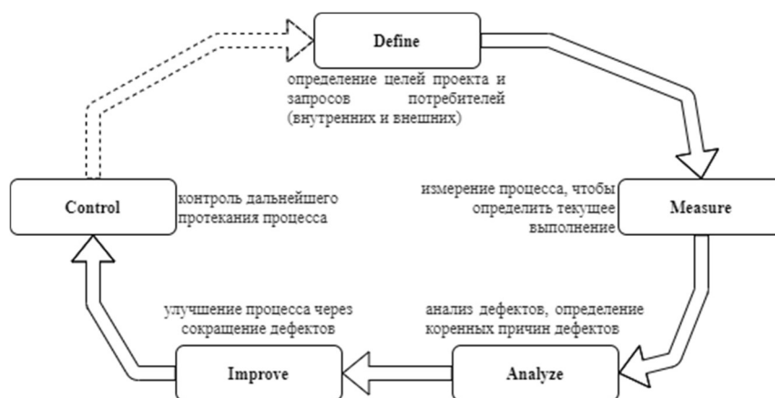
Рисунок 7. Содержание процесса внедрения метода шесть сигм
