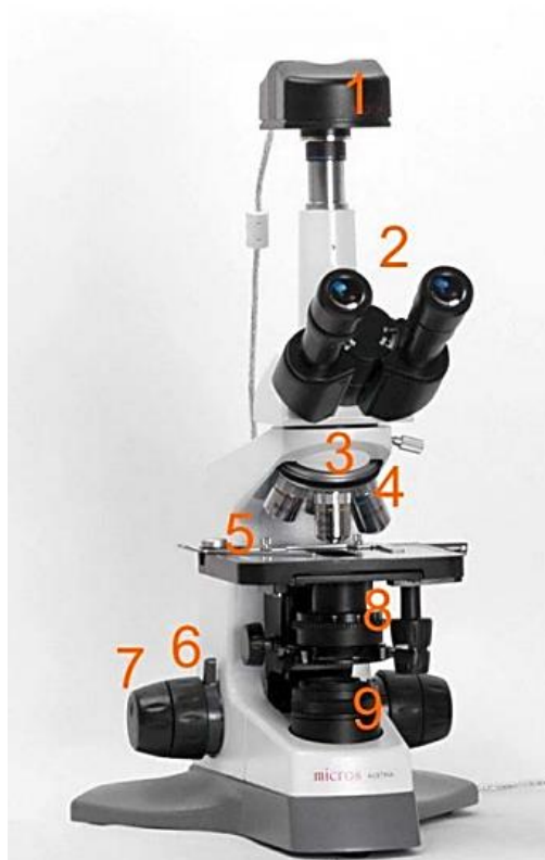
Рис. 21. Основные компоненты современного светового микроскопа [86].
