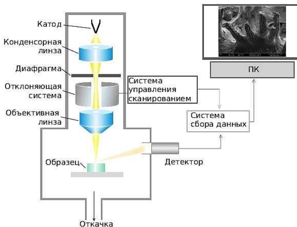
Рис. 22. Схема сканирующего электронного микроскопа [88].
