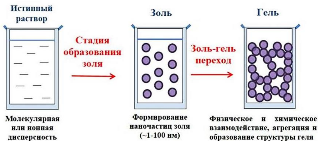
Рис. 1. Схема перехода истинного раствора в золь и затем в гель.
