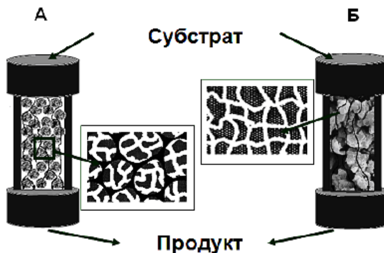
Рисунок 6. Схема, иллюстрирующая движения вещества в упакованных частицами колонках (А) и в монолитных матрицах (Б) [20].
