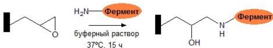
Рисунок 11. Прямая иммобилизация фермента на поверхности ГМА-содержащего полимерного носителя.
