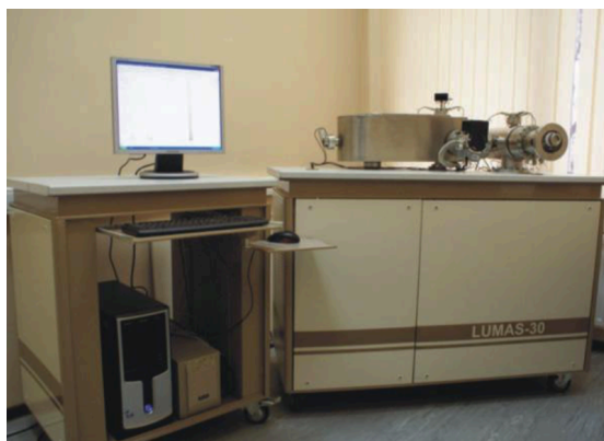
Рис.7 Времяпролетный масс-спектрометр Lumas-30
