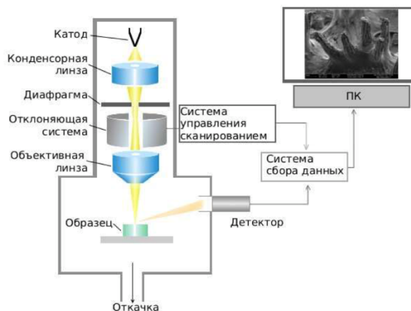
Рис.9 Устройство сканирующего электронного микроскопа
