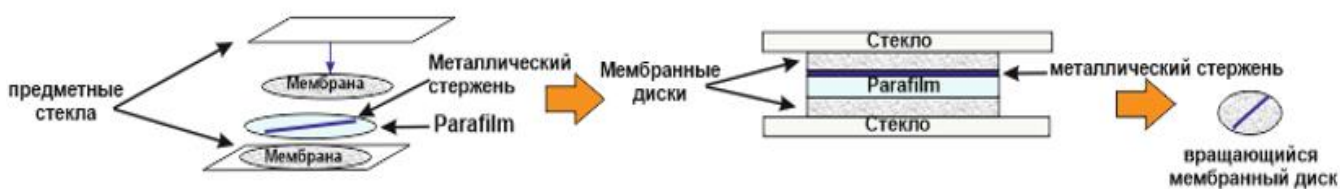
Рисунок 13. Изготовление вращающегося пористого мембранного диска
