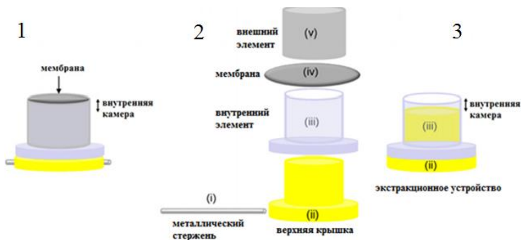
Рисунок 7. Схема устройства для реализации жидкостной микроэкстракции с применением вращающейся мембраны и его сборки [78]
