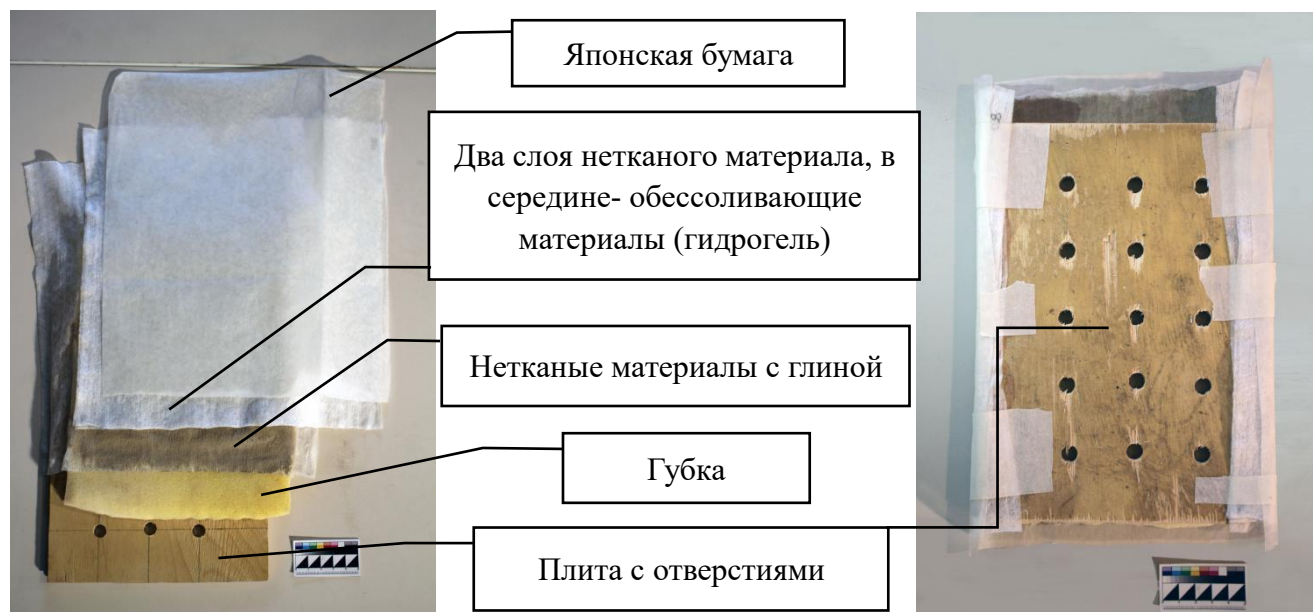
Рис. 79 Структура обессоливающего компресса.
