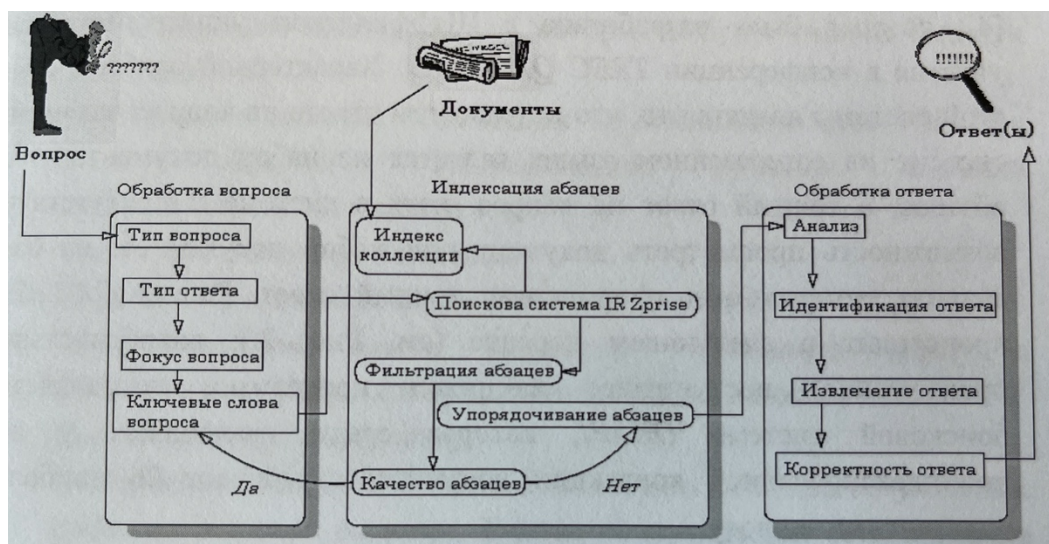
Рисунок 3 – Архитектура VOC Lasso (Захаров 2015: 5)
