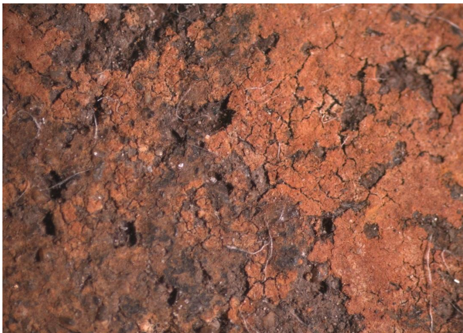
Илл.63 Тесто группы В под микроскопом с объективом 5 крат.
