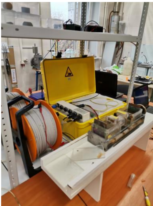
Рисунок 12. Аппаратура SIP Fuchs III и измерительная установка
