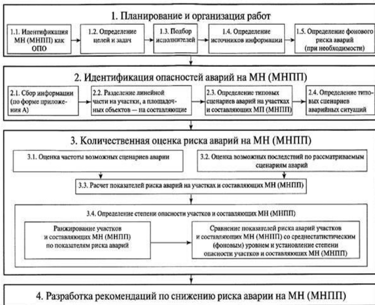
Рисунок 5.1 Блок-схема проведения количественного анализа риска аварий на ОПО МН и МНПП [26]
