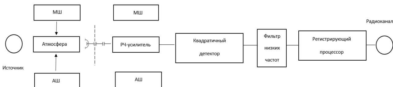
Рис. 10. Схема исследования физического объекта пассивным радиотепловым методом. МШ – мультипликативный шум в атмосфере и усилителе; АШ – аддитивный шум в атмосфере и усилителе; рЧ-усилитель — радиочастотный усилитель (Шарков, 2014; [8])
