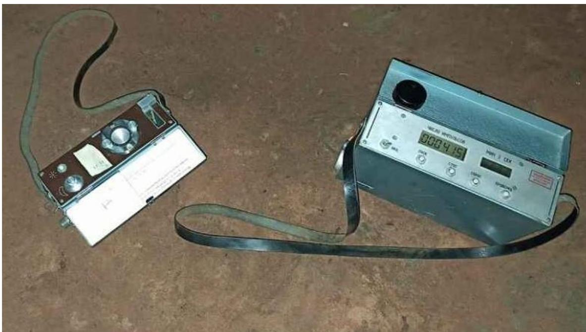
Рис.3. Справа альфа-радиометр РГА-02Т, слева устройство отбора проб анализируемого воздуха типа ВПМ-10-12 с аналитическим аэрозольным фильтром типа АФА-РСП-10. (фотография В.О.Бунина)
